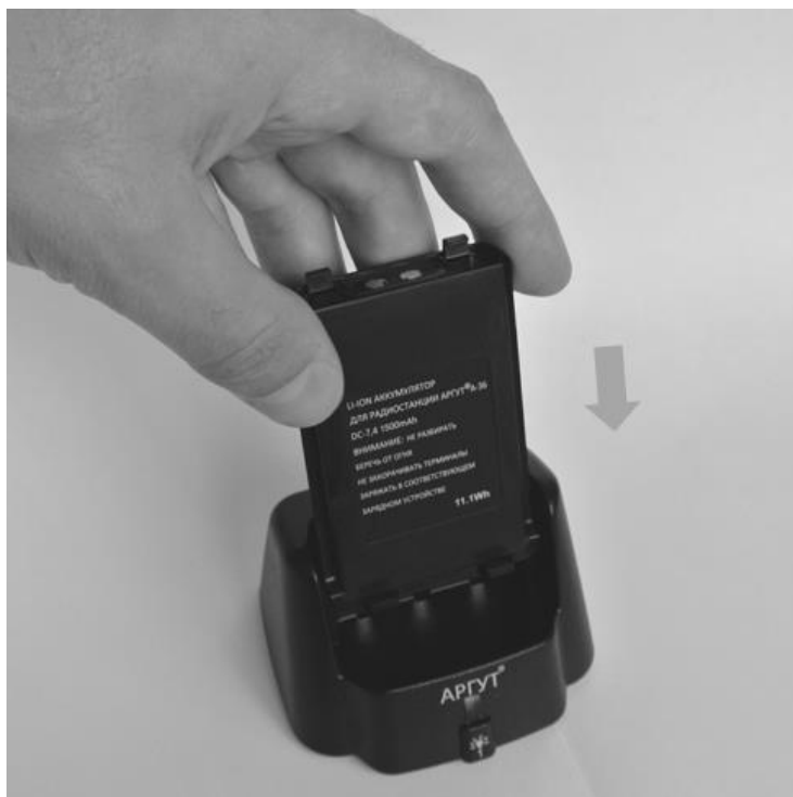
Рис. 7. Установка аккумуляторной батареи на зарядную базу.
