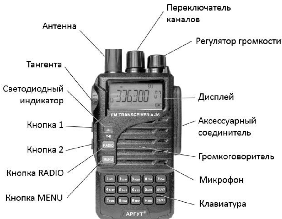
Рис. 1. Расположение органов управления, индикации и соединителей.
